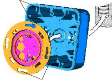
Привинтите считыватель к коробке здесь
