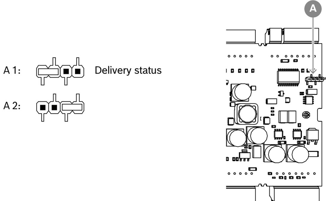
**Figura 4.5:** Localização do jumper de terra no lado inferior
