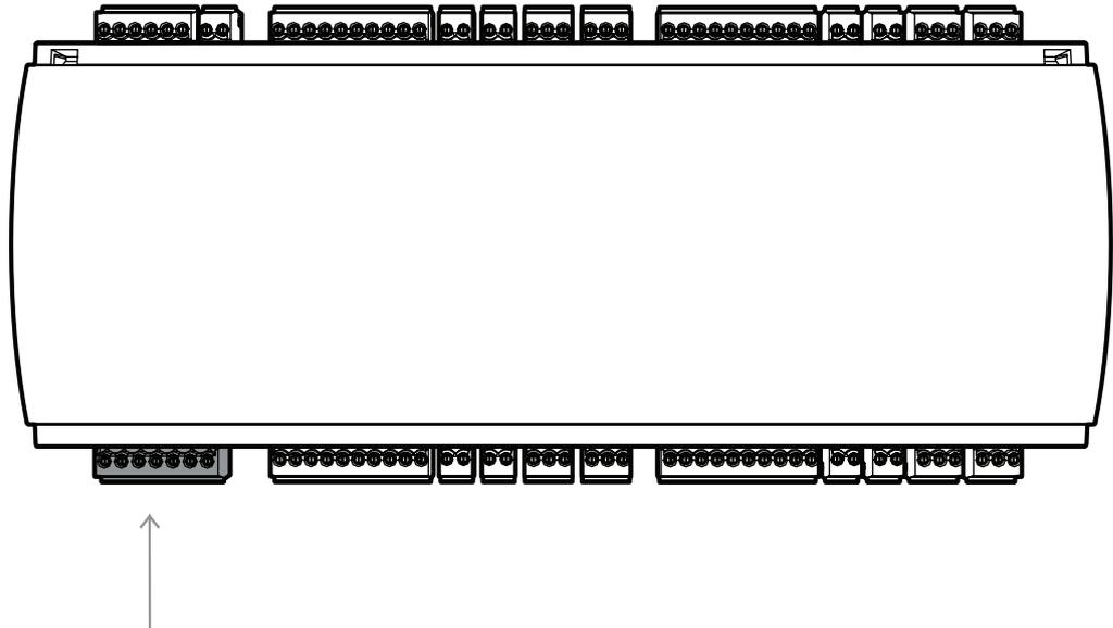
Conecte uma fonte de alimentação externa (10 VCC – 30 VCC) à extensão no pino 1 (positivo) e pino 3 (0 V) do conector de parafuso plugável.
