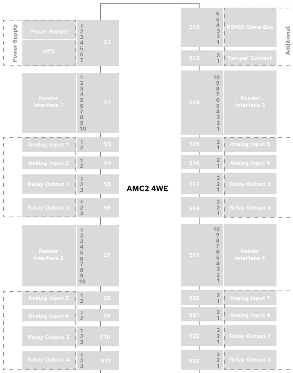
Figura 10.1: Blocos de conectores do AMC2-4WE
