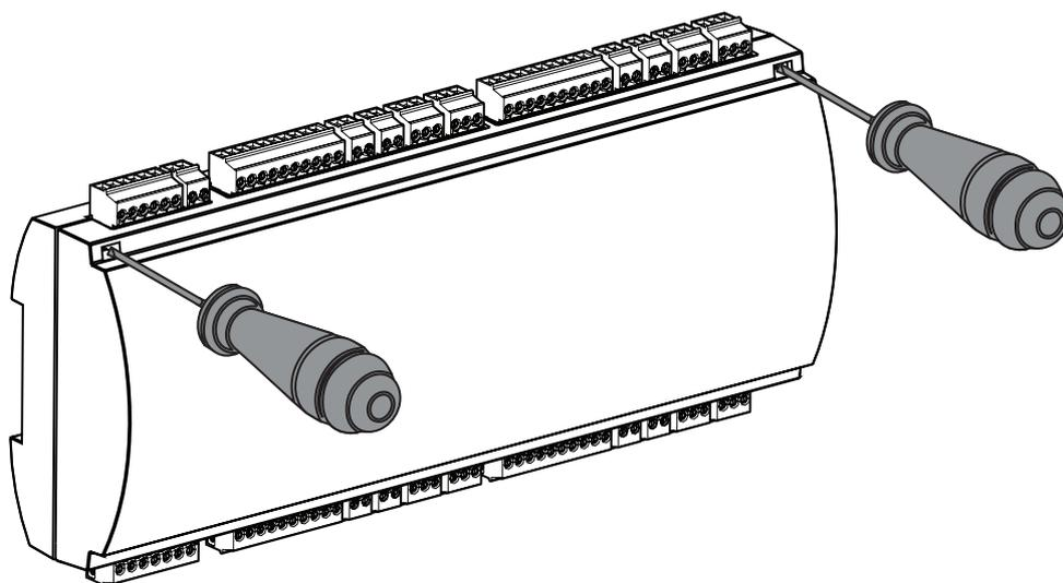
**Figura 4.3:** Abertura da caixa do AMC2-4WE
