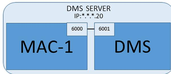
Für eine minimale Systemkonfiguration wird ein MAC benötigt. In diesem Fall kann sich der MAC auf dem DMS-Server befinden.
