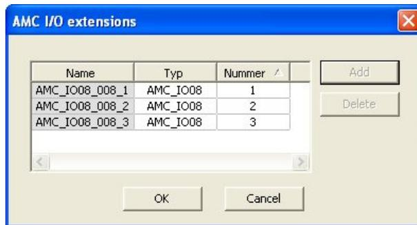
Die AMC Erweiterungen werden je nach Erstellung mit 1, 2 oder 3 nummeriert. Die Nummerierung der Signale beginnt bei jeder Erweiterung mit 01. Die Signalnummer und die Erweiterungsnummer bilden zusammen eine eindeutige ID. Die Signale der AMC Erweiterungen werden auf der Registerkarte des AMC angezeigt, zu dem sie gehören. Zusammen mit den Eingangs- und Ausgangssignalen des AMC können auf diese Weise maximal 56 Signalpaare bereitgestellt werden.
