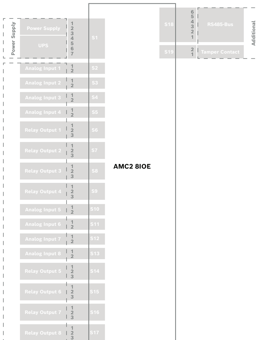
Rysunek 10.1: Schemat blokowy złączy modułu AMC2-8IOE
