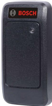
Der ARD-AYK12 RFID-Leser ist ein sehr kleiner, berührungsloser Zutrittskontrollleser. Der Leser wird über eine Wiegand Schnittstelle betrieben. Er ist für die Wandmontage geeignet und unterstützt EM-Ausweise. Eine mehrfarbige LED und ein Signalgeber geben dem Benutzer eine deutliche Rückmeldung während der Bedienung. Der Leser besitzt die Schutzart IP65 und ist daher für Innen- und Außenbereiche geeignet.
