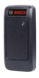
O leitor de proximidade RFID ARD-AYK12 é um leitor de controle de acesso muito pequeno e sem contato. O leitor opera através de uma interface Wiegand. É adequado para montagem na parede e é compatível com cartões EM.
