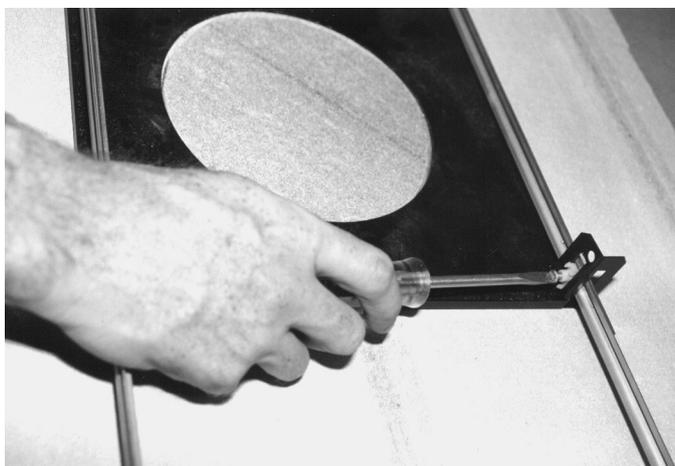
**Figura 7.3:** Aperte o parafuso de fixação do suporte
