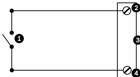
Figura 15.49: N.C. No supervisadas, normalmente cerradas
