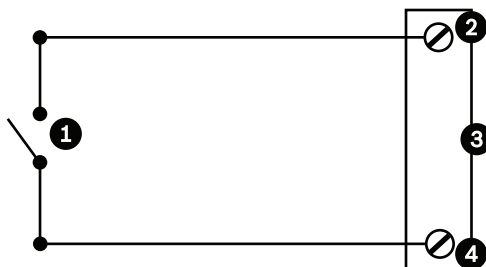
Figura 15.48: N.A. Conexiones no supervisadas normalmente abiertas
