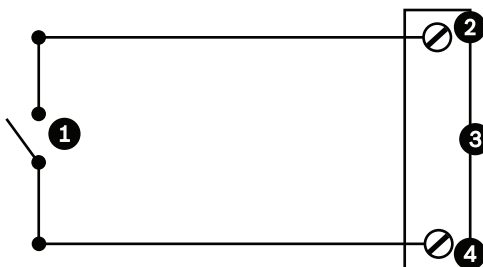
Afbeelding 15.47: N.O. - Normaal open niet-bewaakte aansluitingen
