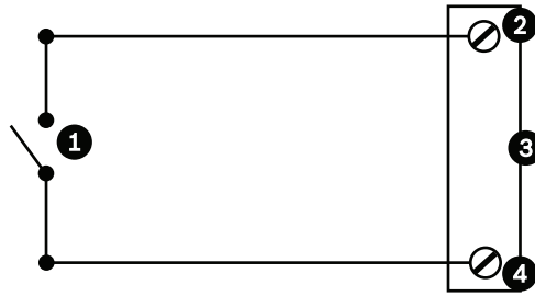
Afbeelding 15.48: N.C. Normaal gesloten niet-bewaakte aansluitingen
