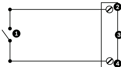
Figura 15.47: NA - Ligações normalmente abertas não supervisionadas
