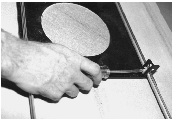
Рисунок 9.32: Затягивание крепежных винтов кронштейна
