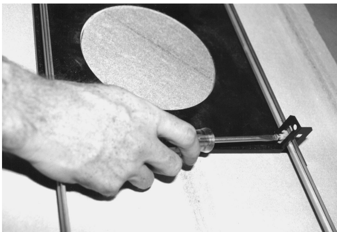
图 9.32: 拧紧支架紧固螺丝
