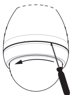
Figure 5.1: Rainure de déverrouillage de la sphère
