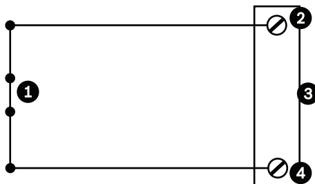
Abbildung 10.5: NC – Anschlüsse für nicht überwachten Öffneralarm
