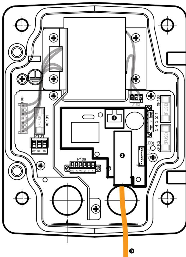
**Figura 10.2:** Modulo Ethernet in fibra ottica installato
