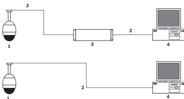
**Figura 13.1:** Configurazione del sistema della telecamera AUTODOME serie 7000
