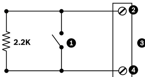
Figura 13.2: N.O.S. - Collegamenti supervisionati normalmente aperti
