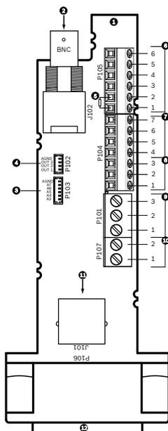
**Figura 10.6:** Collegamenti della scheda di interfaccia tubo
