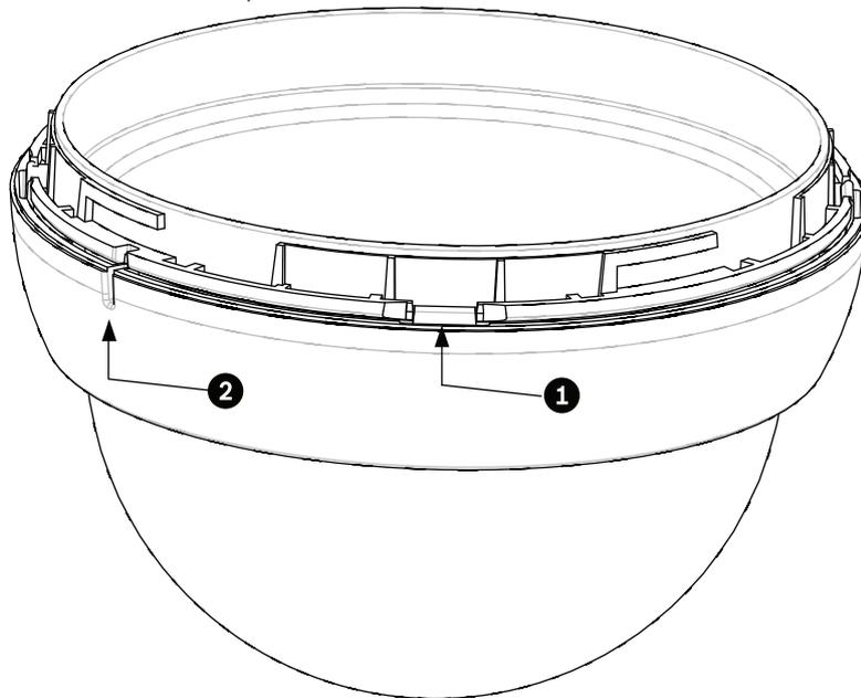
7. Inserire la cupola di ricambio all'interno dell'anello di chiusura e allineare la linguetta di rilascio (numero 2, sopra) sull'anello di chiusura con il foro sulla cupola.
