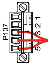
**Figura 9.5:** Alimentazione in uscita a 24 VAC
