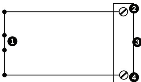
Figura 13.5: N.C. - Collegamenti non supervisionati normalmente chiusi
