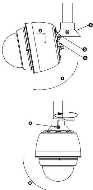
**Figura 10.9:** Fissaggio pendente al tetto/montaggio su tubo
