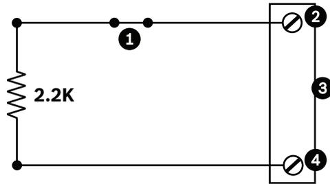
Figura 13.3: N.C.S. - Collegamenti supervisionati normalmente chiusi
