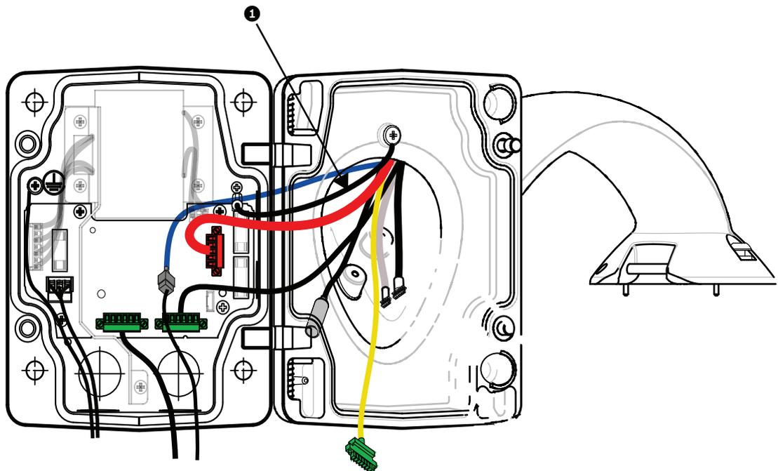
**Figura 9.8:** Collegamenti del braccio pendente al box alimentatore
