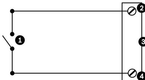
図 10.4: NO接点 - 常開-監視なし接続
