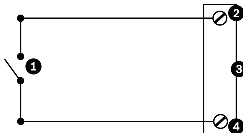
図 13.4: NO接点 - 常開-監視なし接続
