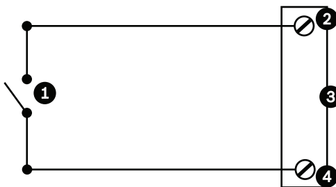
Afbeelding 13.4: N.O. - Normaal open niet-bewaakte aansluitingen
