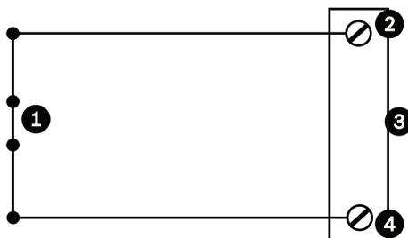
**Figura 13.5:** N.C. Conexões normalmente fechadas não supervisionadas
