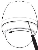
**Figura 12.1:** Abertura de liberação da cúpula do pendente
