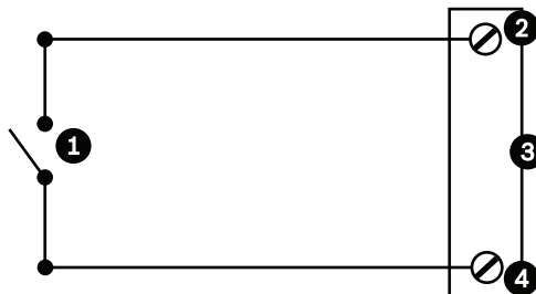
Рис. 13.4: НО - Нормально открытые неконтролируемые соединения
