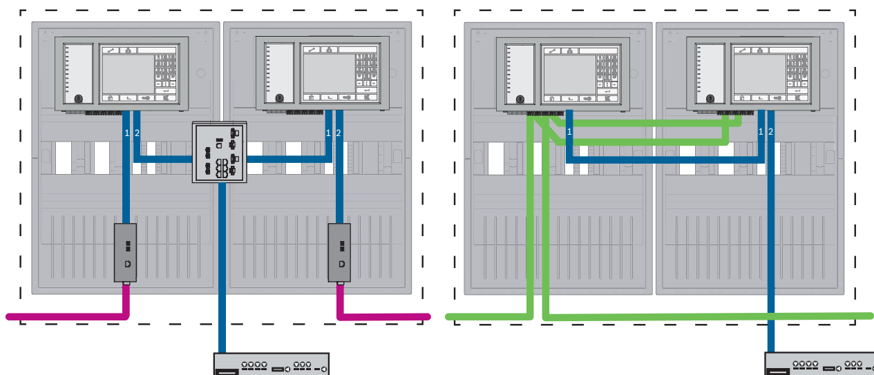
Figura 7.10: Lado izquierdo: en red Ethernet Lado derecho: en red CAN
