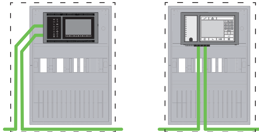
Şekil 7.2: CAN üzerinden panel ağı
