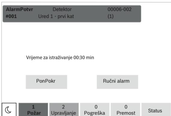
Ako tijekom provjere utvrdite da je alarm autentičan, ručno aktivirajte alarm pritiskom na **Ručni alarm** ili aktivacijom ručnog javljača požara. Evakuacija započinje i aktivira se komunikator za vatrogasnu postrojbu.
