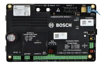
La Centrale B4512 intègre la détection d'intrusion et l'alarme incendie résidentiel au travers d'une même interface utilisateur simple pour les deux systèmes. La centrale B4512 fournit jusqu'à 28 points identifiés individuellement pouvant être divisés en 2 zones. La centrale communique via son port Ethernet intégré, ou via des modules enfichables compatibles qui peuvent envoyer des événements sur le réseau RTC non disponible en Europe (PSTN) ou des communications de réseaux cellulaires.
