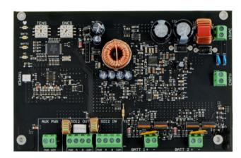
O Módulo de fonte de alimentação auxiliar B520 é um dispositivo auxiliar de expansão de alimentação que se conecta a painéis de controle compatíveis através do barramento SDI2. Esse módulo é supervisionado e comunica todas as mudanças de status ao painel de
