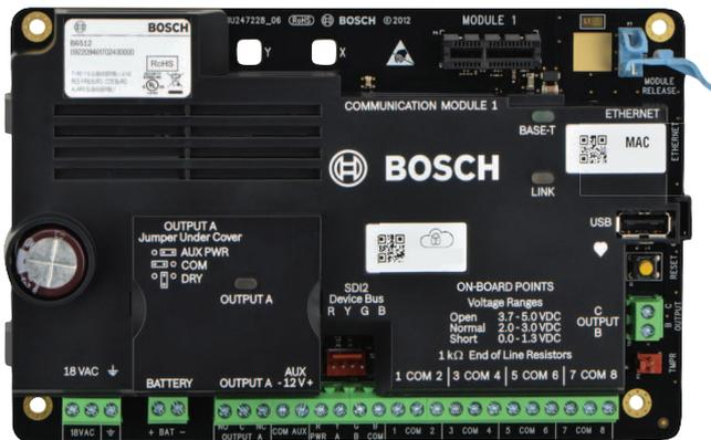
O painel de controle B6512 integra intrusão e incêndio residencial, fornecendo uma interface de usuário simples para ambos os sistemas. O B6512 fornece até 96 pontos individualmente identificáveis que podem ser divididos em seis áreas.
