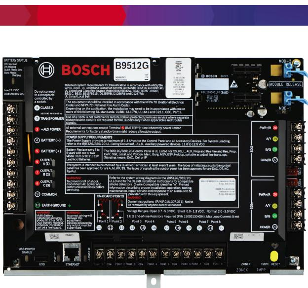
B9512G-CHI报警主机和B8512G-CHI报警主机是Bosch新开发的顶级商业报警主机。B9512G-CHI报警主机集成了入侵和门禁控制，从而为这两个系统提供了一个简单的用户界面。
