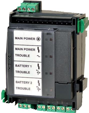
Modul kontrolera baterije BCM-0000-B nadzire napajanje cijele vatrodojavne centrale. Kontrolira punjenje do četiri baterije (od 12 V/24 Ah do 12 V/26 Ah ili od 12 V/36 Ah do 12 V/45 Ah). Punjenje se uključuje prema temperaturi i vremenu.
