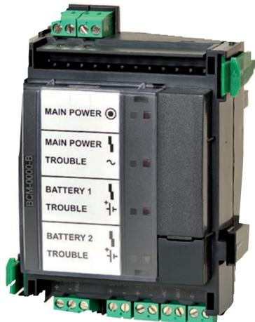
Il modulo di controllo batteria BCM-0000-B monitora l'alimentazione dell'intera centrale di controllo. È in grado di controllare la ricarica di quattro batterie (da 12 V/24 Ah a 12 V/26 Ah oppure da 12 V/36 Ah a 12 V/45 Ah) in funzione della temperatura e del tempo.
