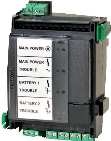
BCM-0000-B napojni modul s nadzorom akumulatora nadgleda napajanje cele upravljačke table. On upravlja punjenjem do četiri akumulatora (12 V/24 Ah do 12 V/26 Ah ili 12 V/36 Ah do 12 V/45 Ah). Punjenje se uključuje na osnovu temperature i vremena.
