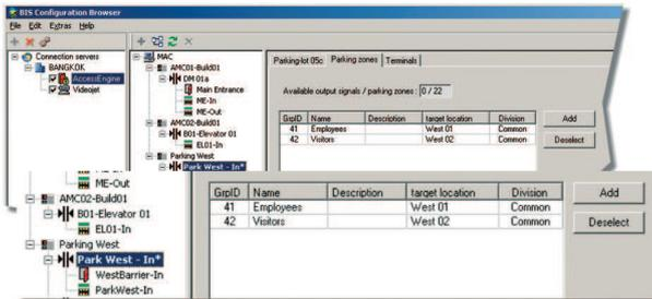
Este recurso permite definir e utilizar o modelo de porta para “estacionamento”. Este modelo contém o controle de duas barreiras (para entrada e saída) e seus semáforos, as quais impedem o acesso quando o estacionamento atinge a capacidade máxima. O acesso a estacionamentos pode ser regulamentado por um leitor de longa distância e cartão de ID, ou por câmera e placas veiculares.
