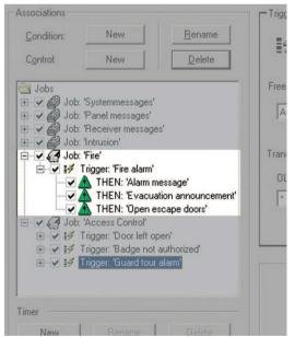
Il cuore del sistema, la macchina a stati (State Machine) provvede al monitoraggio di tutti gli eventi in entrata e le richieste operatore e, se lo si desidera, può intraprendere le azioni stabilite da regole definite dall'utente, alleggerendo gli operatori.
