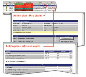
Piani d'azione o flussi di lavoro in funzione degli allarmi forniscono all'operatore informazioni dettagliate in funzione degli eventi, come procedure operative standard, immagini live, pulsanti di controllo, ecc. È sufficiente creare e assegnare un piano d'azione a ciascun tipo di allarme possibile nel sistema, ad es. allarme incendio, accesso negato, allarmi tecnici, ecc.
