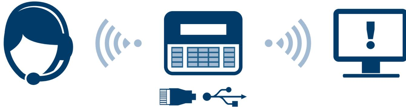
Avec la centrale vous avez la possibilité de vous connecter via le réseau Ethernet ou de données cellulaire pour acheminer les messages d'alarme vers le centre de surveillance. Vous réduisez ainsi les coûts et améliorez la sécurité, puisqu'il n'est plus besoin de recourir à une ligne téléphonique.
