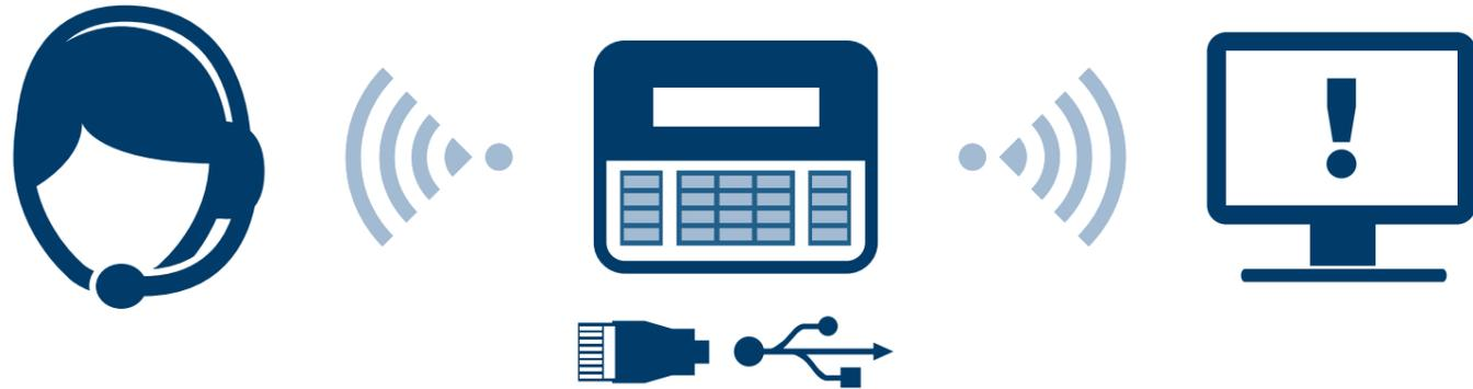
Use sua rede de dados Ethernet ou celular com seu painel de controle para enviar transmissões de alarme para a estação de monitoramento central – o que elimina a necessidade de um telefone, reduz os custos e aumenta a segurança.
