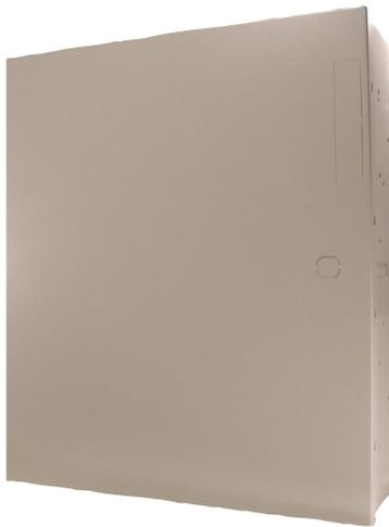
La AE1 es una caja de protección gris que incorpora un interruptor de bucle antisabotaje opcional para controlar la puerta. Está compuesta de acero laminado frío de 1,0 mm de grosor con un cierre con pasador. Las dimensiones son 35,6 cm x 31,8 cm x 7,6 cm (14 pulg. x 12,5 pulg. x 3 pulg.).
