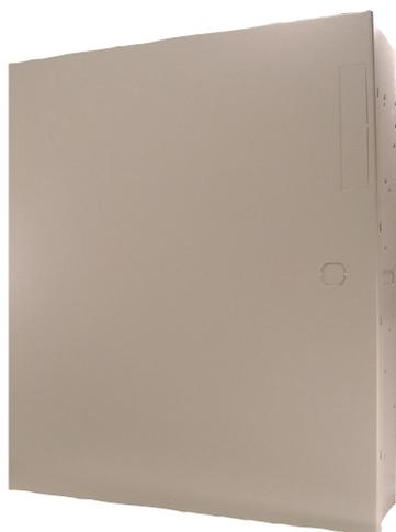
A AE1 é uma caixa cinzenta que possui um interruptor contra sabotagem opcional para monitorização da porta. É fabricada em aço laminado a frio com 1,0 mm de espessura e inclui uma fechadura com chave. Dimensões: 35,6 cm x 31,8 cm x 7,6 cm (14 pol. x 12,5 pol. x 3 pol.).
