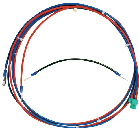
Der Kabelsatz CBB 0000 A ist erforderlich, wenn die Energieversorgung in einem separaten Energieversorgungsgehäuse untergebracht ist. Das Verbindungskabel vom Batterieregler-Modul BCM-0000-B zu den Batterien hat eine Kabellänge von 180 cm.
