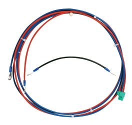
Le jeu de câbles CBB 0000 A est requis lorsque l'alimentation se trouve dans un boîtier d'alimentation distinct. Le câble de raccordement entre le module de contrôleur de batterie BCM-0000-B et les batteries mesure 180 cm.
