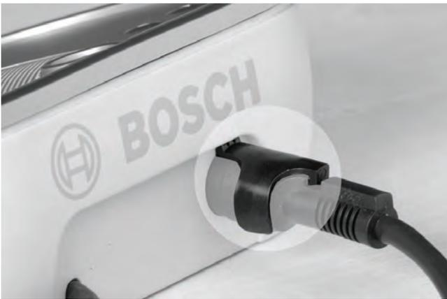
Abrazaderas de cable para unidades de debate DCN-DISCLM, que fijan de forma segura los cables en bucle a la siguiente unidad.
