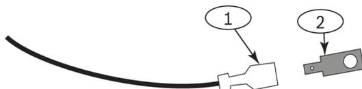
**Figura 2.1: Adattatore di terminale per il collegamento alla batteria D1218**
