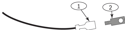
Rysunek 2.1: Adapter zacisku umożliwiający podłączenie do akumulatora D1218
