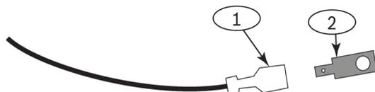
**Figura 2.1: Adaptador de terminal para conexão à bateria D1218**
