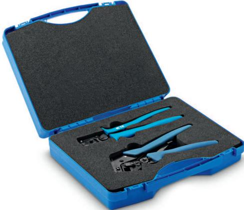
Toolkit Kabel Sistem DICENTIS berisi dua alat unik untuk memasang konektor sistem DICENTIS ke kabel instalasi/jaringan sistem yang panjangnya disesuaikan. Satu alat digunakan untuk menghubungkan dua kontak kabel daya, satunya lagi untuk menghubungkan delapan kontak ke empat kabel sinyal pasangan berpilin CAT-5e pada kabel instalasi/jaringan sistem. Alat ini disediakan di dalam kotak yang kokoh, sehingga kedua alat dijamin akan terlindungi ketika diangkut maupun disimpan.
