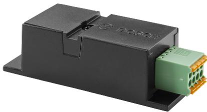
このアクセサリを DICENTIS 通訳デスクに接続すると、次の3つの機能が備わります。ブースの外側のブースオンエアインジケータを制御します。ブースの外側の電話に着信があることを通訳デスクに表示します。ブースの内側のセンサーで CO2 レベルが非常に高いことが検出されたことを通訳デスクに表示します。このアクセサリは、外部インターフェイスと DICENTIS 通訳デスクの間にガルバニック絶縁を提供します。USB 2.0 タイプ A-B ケーブル（別売）で通訳デスクに接続されます。
