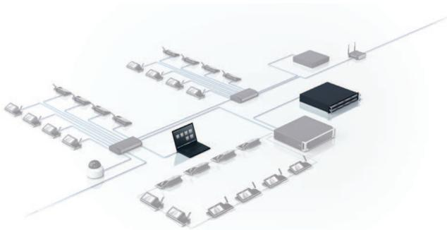
Il modulo software Controllo telecamera DICENTIS offre la possibilità di interfacciare il sistema per conferenze DICENTIS e il sistema wireless DICENTIS con telecamere IP. Questo software seleziona l'attivazione di telecamere fisse o preposizionate (ad esempio, le telecamere Bosch HD Conference Dome) al fine di visualizzare l'oratore attualmente attivo in una riunione.
