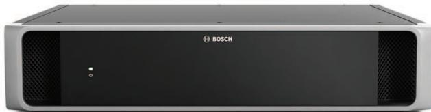
電源スイッチングハブはオーディオ電源スイッチングハブと合わせて、DICENTIS ネットワークに電源を供給するために使用します。内蔵のイーサネットスイッチはシステムすべてのデバイスをネットワークに接続します。ループスルー接続のサポートにより、DICENTIS デバイスを別の DICENTIS デバイスに接続することや、ループ終端の DICENTIS デバイスを（オーディオ）電源スイッチングハブに接続してケーブル冗長構成にすることも可能です。電源スイッチングハブはユーザー制御を受け付けず、完全にリモート制御されます。
