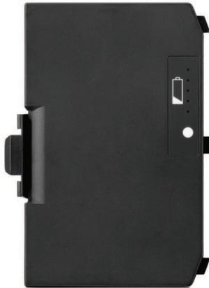
该可充电电池组(DCNM-WLIION)是DICENTIS无线会议系统中的无线设备(DCNM-WD和DCNM-WDE)的电源。该电池组是高容量锂电类型,完全充电后可支持长达24个小时(DCNM-WD)和20个小时(DCNM-WDE)的使用。电量耗尽后,使用充电器(DCNM-WCH05)为该电池组完全充满电大约需要三个小时。这使得您可以灵活地安排充电。该“智能”电池组内置了微型处理器来控制充电电流并防止过载。
