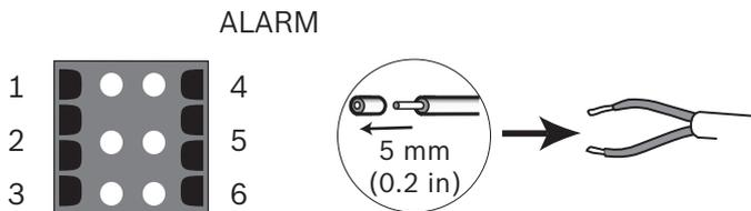
图 4.4 报警和继电器连接器引脚
