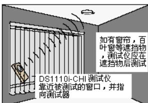
应使用DS1101i-CHI玻璃破碎测试仪进行该项测试。DS1101i-CHI产生使探测器报警的高频音，以进一步校验适当的安装位置。
