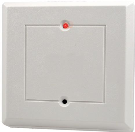
I rivelatori DS1102i utilizzano la tecnologia di analisi del suono (SAT) basata su microprocessore per identificare le frequenze specifiche associate alla rottura del vetro. DS1102i e DS1102i-CHI possono essere utilizzati per rilevare la rottura del vetro in lastre, temprati, laminati e retinati. Una funzione di test ambientale integrata avverte l'installatore dei rischi di falsi allarmi in ambienti difficili. I rivelatori quadrati possono essere montati su soffitti o pareti.
